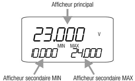
Alors que l'afficheur principal apparaît dès que le multimètre est allumé, il faut activer les deux afficheurs secondaires en appuyant sur la touche DATA|CLEAR (sauf en position M $\Omega$ @...V, où les afficheurs secondaires apparaissent dès que la fonction a été sélectionnée).
